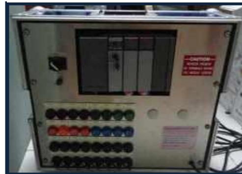
Allen Bradley SLC 5/03
